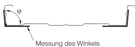
Abbildung 3.26: Messung des Eckwinkels Gurt/Steg
