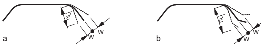
Figure 2.19: Ondulation du bord longitudinal
