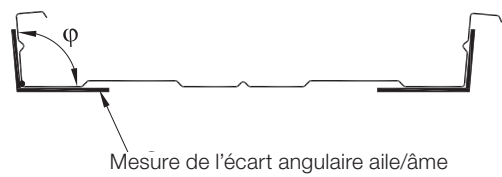
Figure 3.26 : Mesure de l'écart angulaire aile/âme
