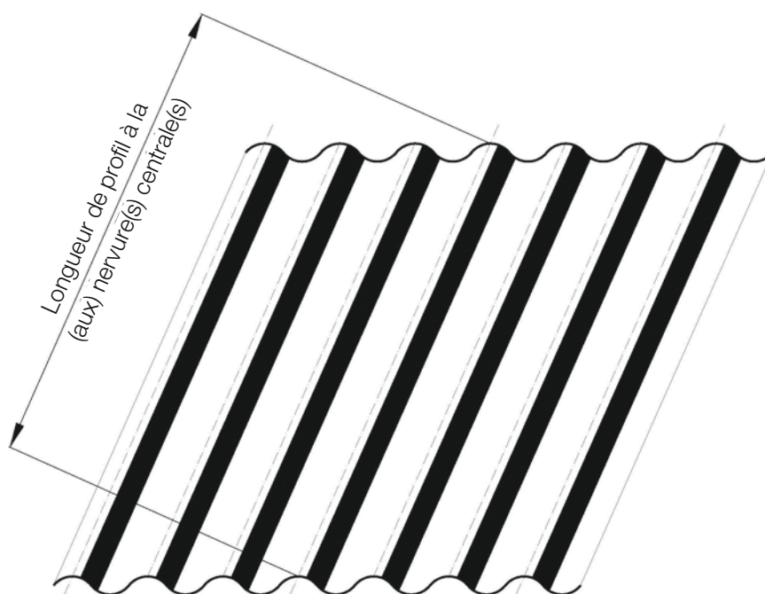
Figure 3.18 : Mesure de la longueur de profil à la (aux) nervure(s) centrale(s)
