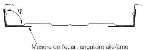
Figure 3.26 : Mesure de l'écart angulaire aile/âme
